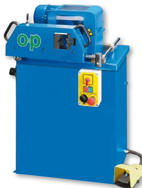
◀ MANDRINO SINGOLO A DOPPIO TAGLIENTE PER OGNI DIAMETRO SINGLE MANDREL FOR EACH DIAMETER SHARP WITH DOUBLE KNIFE
