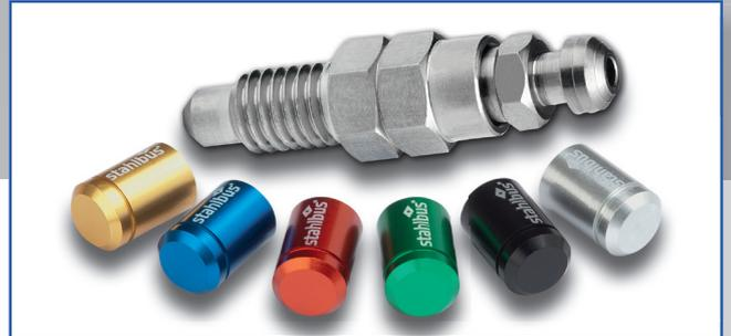
Das **stahlbus®-Entlüftungsventil** besteht aus zwei Teilen mit einer Rückschlagfunktion. Beim Entlüften und Befüllen wird nur das Oberteil des Ventils gelöst, in das eine O-Ring-Dichtung integriert ist. Dadurch kann weder Luft noch Brems- oder Hydraulikflüssigkeit durch das geöffnete Gewinde gelangen. Weiterhin entfällt durch das Rückschlagventil das sonst fehleranfällige synchrone Auf- und
