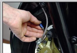
Nachdem die herkömmliche Entlüftungsschraube entfernt wurde: Einbau des stahlbus®-Entlüftungsventils am Bremszylinder.
