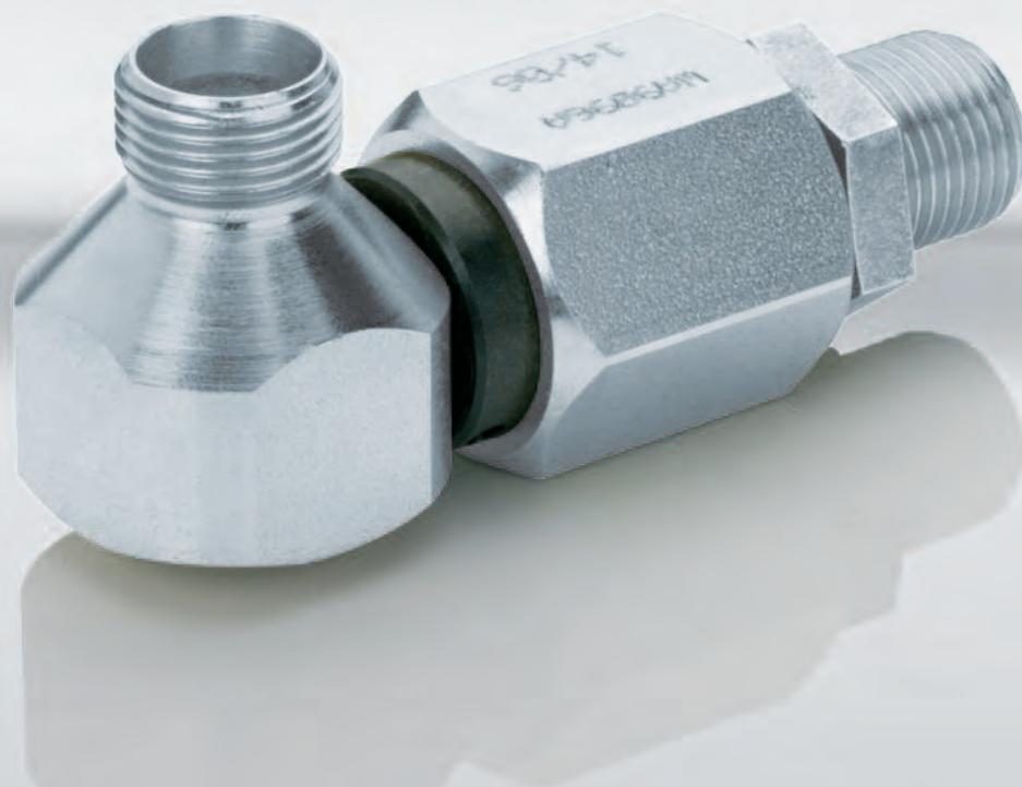
Axial- und Winkeldrehgelenke sind in der Hydraulik bei einigen Anwendungen unverzichtbar geworden. Dreh- und Schwenkbewegungen zwischen Schlauch und Maschinenteilen werden ausgeglichen und verhindern somit einen vorzeitigen Verschleiß oder Ausfall.
