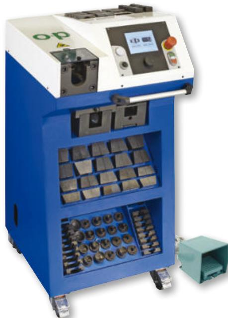
**UTENSILI SVASATURA 37°:** forniti secondo norma UNI ISO 8434-2 e DIN 3949
