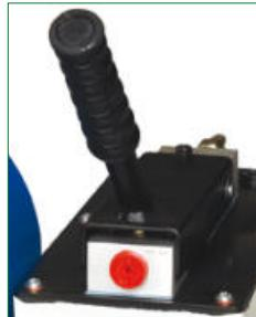
◀ POMPA AZIONAMENTO PNEUMO IDRAULICO
