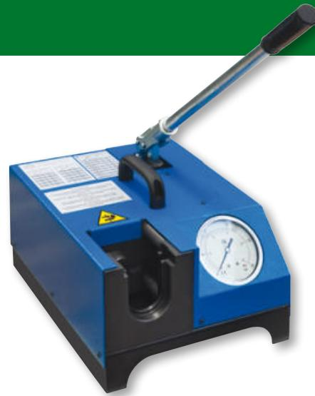
UTENSILI SVASATURA 37°: forniti secondo norma UNI ISO 8434-2 e DIN 3949
