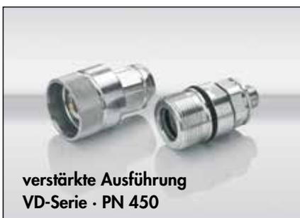
Diese traditionelle Kupplung als schraubbare Leitungsverbindung ist sehr robust ausgeführt und somit für härteste Einsatzbedingungen im Industrie- und Baumaschinenbereich einsetzbar. Ein Kuppeln unter Druck ist bis zu max. 100 bar einseitig möglich.
