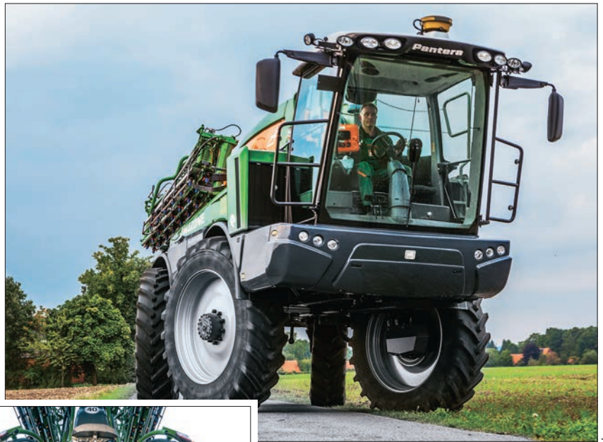
Amzone verbindet beim Fahrwerk für die selbstfahrende Feldspritze Pantera 4502 Hydraulik mit elektronischer Regelung.
