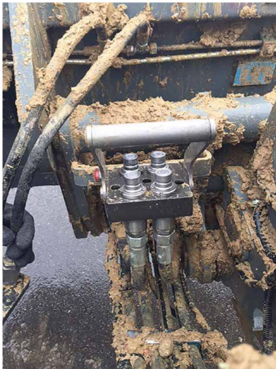
Durch die robuste und markterprobte Technik aus dem Portfolio zweier etablierter Hersteller ist gewährleistet, immer die optimale Kupplungstechnik für die jeweilige Anwendung zu finden. Je nach System können bis zu zehn Leitungen verbaut werden. Damit wird schnelles Kuppeln und Entkuppeln mit absoluter Verwechslungssicherheit erreicht.
