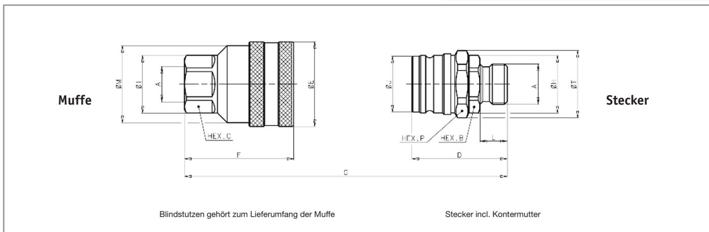
Innengewinde DIN 3852 · Muffe wird immer mit Blindstutzen geliefert.
