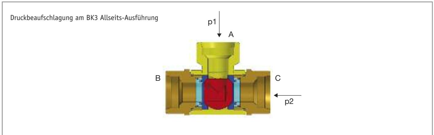
Bei einer Allseits-Ausführung darf der Druck  $p_2$  an der abgesperrten Seite größer sein als der Druck  $p_1$ ! Wenn dies der Fall ist, wird der Allseitskolben und die Kugeldichtung gegen die Kugel gedrückt und sperrt den Anschluss zuverlässig nach A und B ab.
