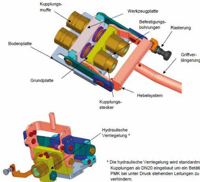
\* Die hydraulische Verriegelung wird standardmäßig bei Kupplungen ab DN20 eingebaut um ein Betätigen der PMK bei unter Druck stehenden Leitungen zu verhindern.
