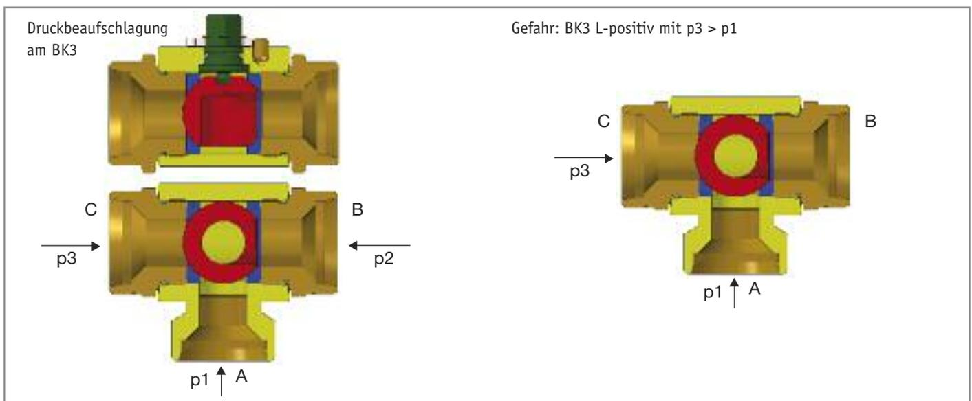
Bei positiver Überdeckung sind in 90° Stellung der Kugel alle Anschlüsse geschlossen, wenn  $p_2$  und  $p_3$  kleiner sind als  $p_1$ ! Eine Druckbeaufschlagung ist nur am mittleren Anschluss A möglich. Durch die Umleitung des Mediums wird allerdings die Durchflussmenge reduziert und das Medium erwärmt.
