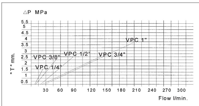
Rohrbruchsicherungen sind auf den maximalen Volumenstrom eingestellt.
