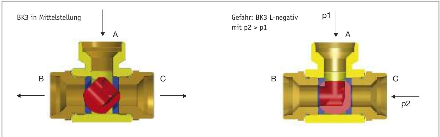
Mit diesem Typ Kugelhahn wird das am Anschluss A ankommende Medium nach rechts oder nach links umgelenkt. In der Mittelstellung (45°) wird das Medium auf beide Seiten (Anschluss B und C) verteilt. Eine Absperrung aller Anschlüsse in Mittelstellung ist nicht möglich.
