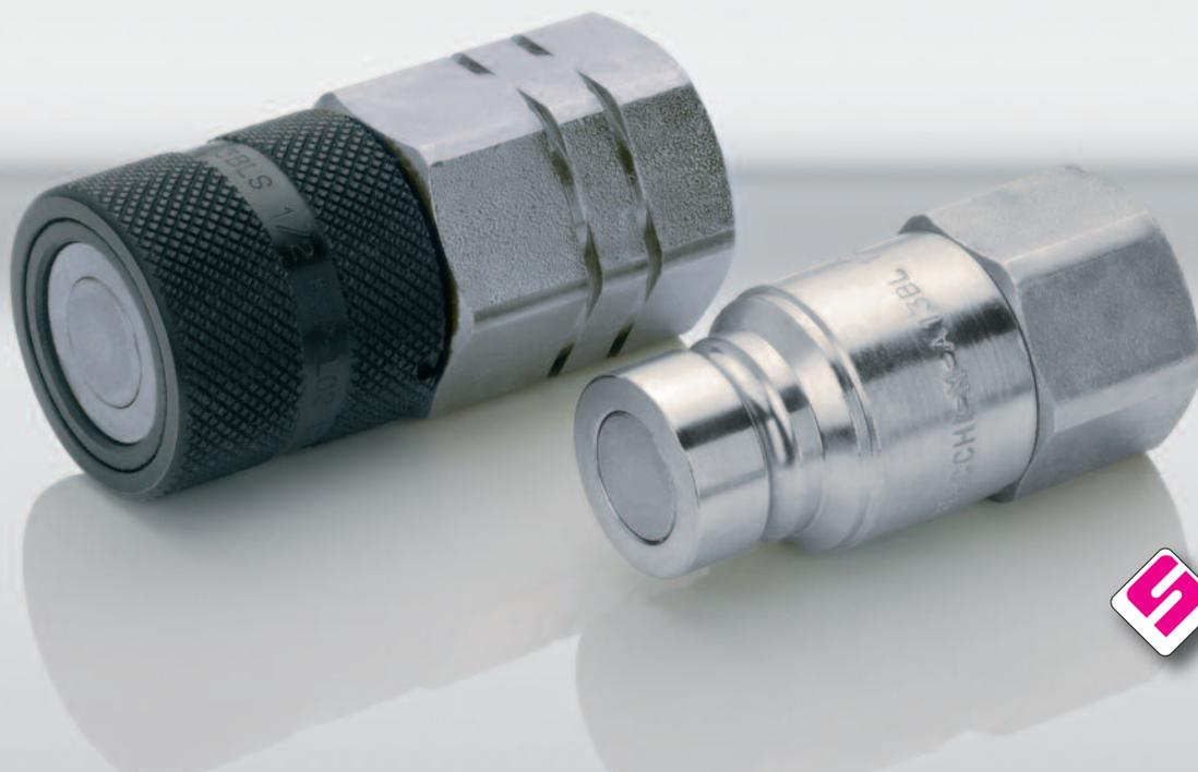
Für extreme Ansprüche der Anwendung gibt es die flachdichtende Kupplung der A-Serie in der Sonderausführung „BL“. Diese Kupplung wurde speziell für eine **erhöhte Anzahl an Lastwechseln** entwickelt und ist somit deutlich leistungsfähiger als die herkömmliche Flat-Face-Kupplung. Die Lebensdauer der „A-BL“ liegt bei ca. **3-4 Mio.** Lastwechseln, je nach Einsatzfall.
