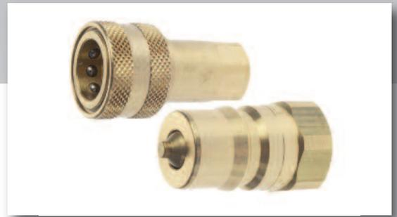
Die Kupplungen der IRBO-Serie aus Messing sind nach der ISO 7241-1-B gefertigt. Die in der Kupplung enthaltenen Federn und Kugeln sind aus Edelstahl. Die IRBO-Serie ist korrosionsbeständig und wird hauptsächlich in Industrieanlagen eingesetzt.
